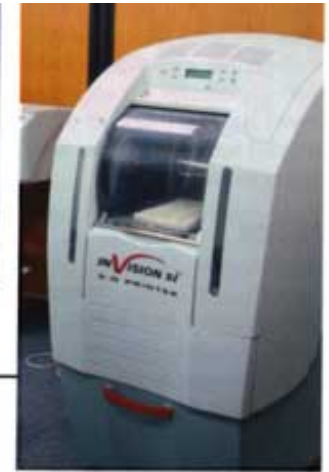
À l'aide de cette « imprimante 3D » (ci-contre), il est possible de créer le prototype d'une pièce à l'échelle 1 (ci-dessus).
