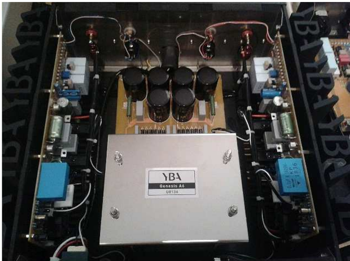
Le cœur du bloc de puissance A 6 : un transformateur en double C à grains orientés Made in France. Deux cartes monophoniques se chargent de délivrer les 2 x 150 watts Sous 8 ohms.
