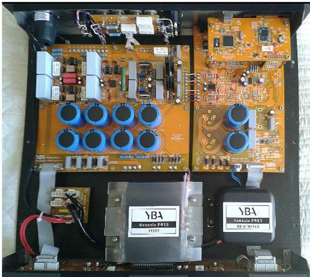
Le cœur du PRE 5 : un transformateur en double C à grains orientés Made in France. Un second transformateur est destiné à alimenter la carte de conversion numérique.
