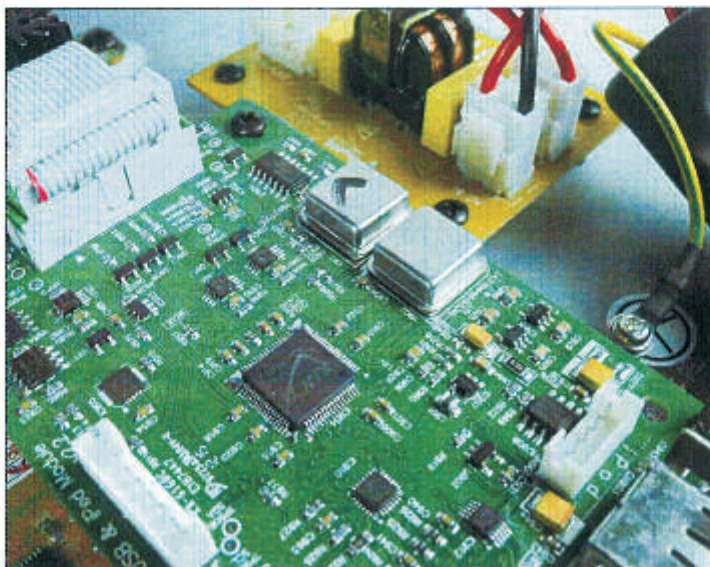
• Der XMO5-Receiver bekommt von zwei getrennten, sehr hochwertigen Quarzen stabile Takte für die beiden „Frequenzfamilien“
