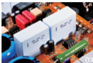
01、拆开Genesis PRE5的外壳，左边为前级模块，右边是数字模块，另外前级部分采用8个4700 \mu F的大水塘电容；02、上层为蓝牙和USB接收模块，下层为同轴、光纤的接收模块；03、YBA定制的方形浅蓝色薄膜电容；04、一如既往地使用了C型变压器，数字部分和模拟部分由两个变压器分开供电；05、解码采用Cirrus Logic的CS4398芯片；06、前级放大部分
