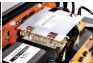
01、拆开Genesis PRE5的外壳，左边为前级模块，右边是数字模块，另外前级部分采用8个4700 \mu F的大水塘电容；02、上层为蓝牙和USB接收模块，下层为同轴、光纤的接收模块；03、YBA定制的方形浅蓝色薄膜电容；04、一如既往地使用了C型变压器，数字部分和模拟部分由两个变压器分开供电；05、解码采用Cirrus Logic的CS4398芯片；06、前级放大部分
