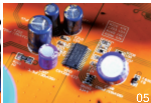
01、拆开Genesis PRE5的外壳，左边为前级模块，右边是数字模块，另外前级部分采用8个4700 \mu F的大水塘电容；02、上层为蓝牙和USB接收模块，下层为同轴、光纤的接收模块；03、YBA定制的方形浅蓝色薄膜电容；04、一如既往地使用了C型变压器，数字部分和模拟部分由两个变压器分开供电；05、解码采用Cirrus Logic的CS4398芯片；06、前级放大部分
