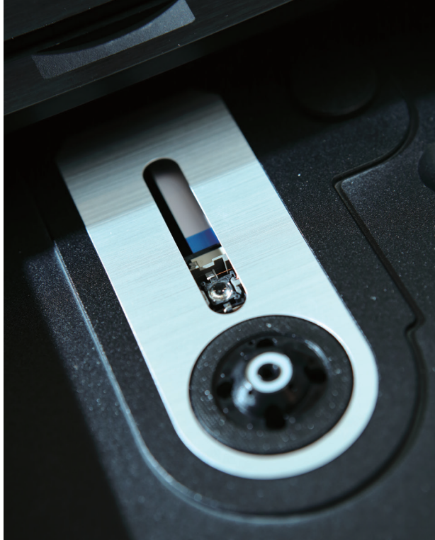
顶部揭盖式的设计，内里装有三洋光头 HD850，PHILIPS 的 SAA7824HL CD 伺服系统
