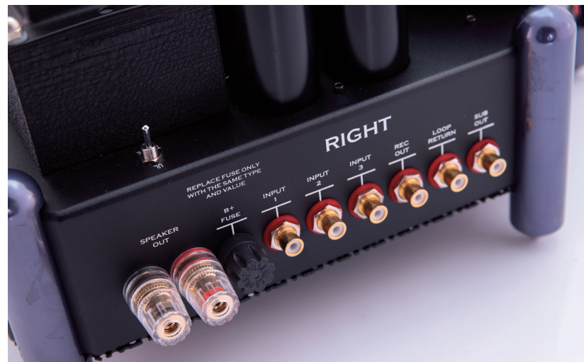
ช่องต่ออินพุตและขั้วต่อสายลำโพง และสวิตช์ปรับโหมด Triode กับ Ultra Linear แยกซ้าย-ขวา คนละฝั่ง
