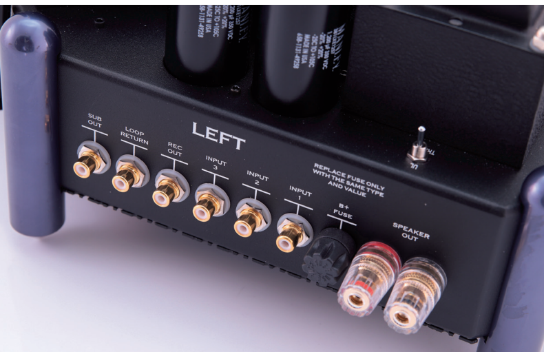
ช่องต่ออินพุตและขั้วต่อสายลำโพง และสวิตช์ปรับโหมด Triode กับ Ultra Linear แยกซ้าย-ขวา คนละฝั่ง
